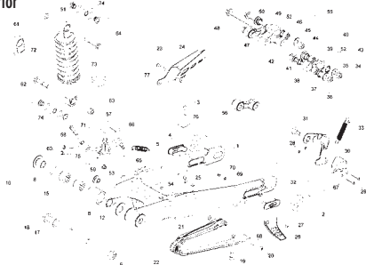
TAV.15 Forcellone posteriore - Rear fork - Fourche arriere - Hinterradschwinge - Horquilla posterior
